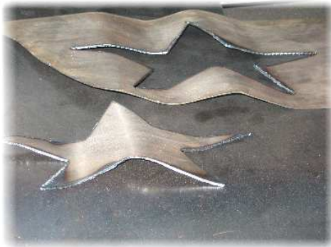
Cięcie plazmowe z wykorzystaniem kontrolera THC
