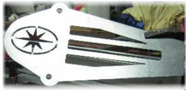
Cięcie plazmowe z wykorzystaniem kontrolera THC
